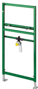
Viega Eco Plus urinoarelement 8164.5 H x B x D: 1130/1300 x 490 x 100-200 mm
