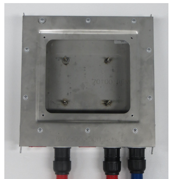
Fig.2. Provstycket utan serviceluckan med tre monterade anslutningstycken för skyddsror
